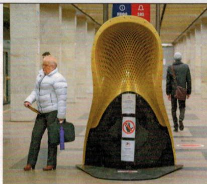
Dieses Gerät in der Botanischeski-Sad-Station in der Moskauer U-Bahn dämpft durch Interferenz die Umgebungsgläusche
